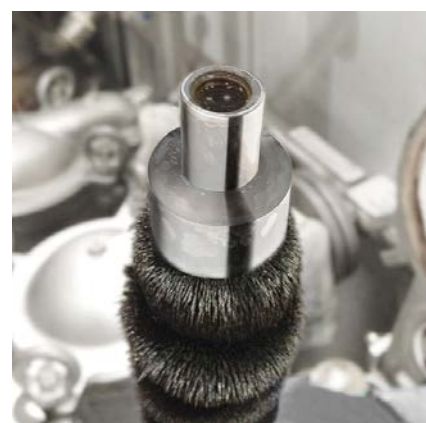
Ausgebauter Magnetstab mit anhaftenden metallischen Partikeln
