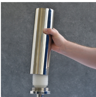
Abb. 2: Abschrauben des Deckels vom Kerzenfiltergehäuse.
