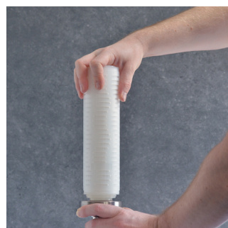
Neue Filterkerze einsetzen.
