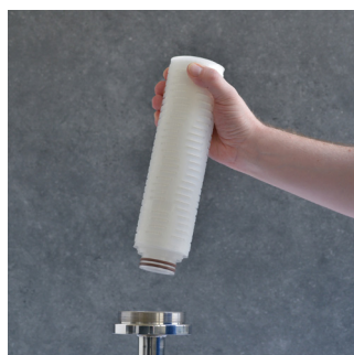
Abziehen der verbrauchten Filterkerze
