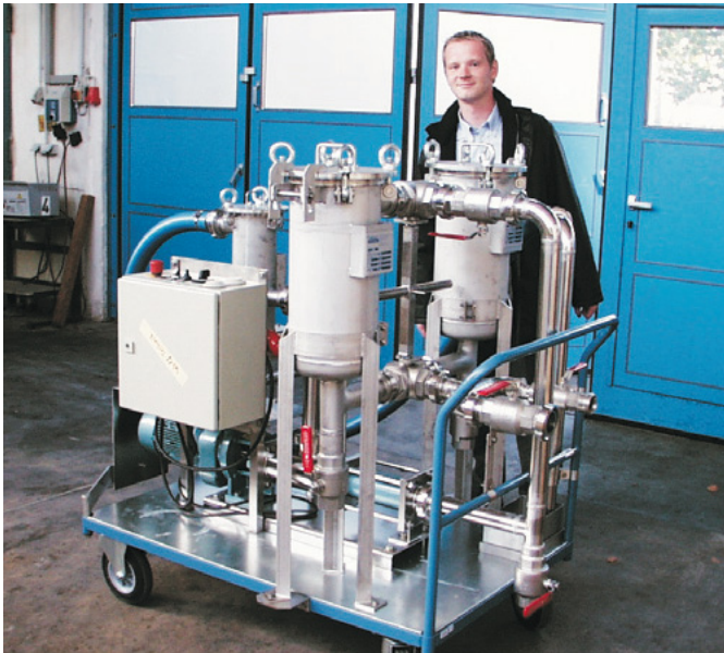
Fahrbare Doppelfilteranlage mit Exzentrerschneckenpumpe und Überströmventil.
