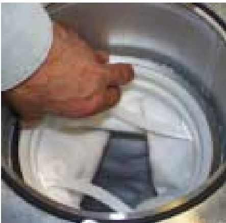
4. Neuen Filterbeutel in den Stützkorb stecken
