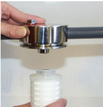
3. Neues Filterelement aufstecken
